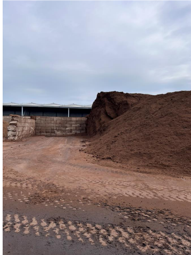
Stofhinder door de buitenopslag zeer fijn materiaal. Mogelijk niet goed natgehouden
